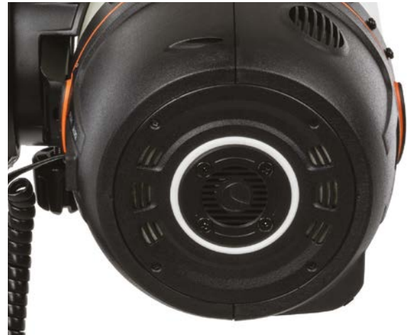
Abb. 8: Der LED-Ring an der hinteren Zelle des Origin bietet einen Überblick über den Status.
