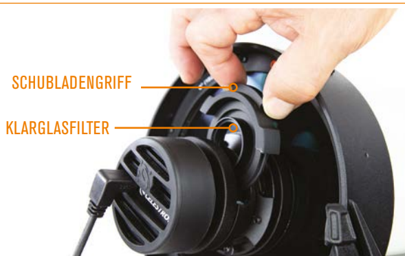
Abb. 15: Fassen Sie den Griff der Schublade mit Ihren Fingern und ziehen Sie ihn nach außen, um ihn von den Magneten zu lösen.
