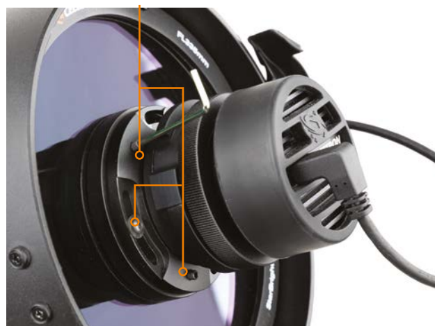
ABB. 34: Justieren Sie die Neigung der Linsengruppe (und der Kamera) mit den Kollimationsschrauben.
