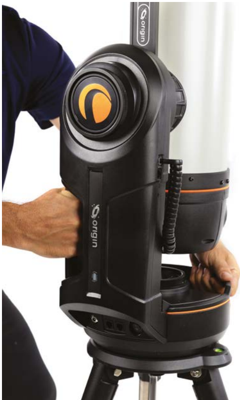
ABB. 31: Mit den Griffen an der Gabel und der Montierung können Sie Ihr Origin anheben
