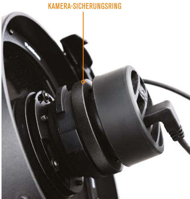
ABB. 30: Wenn Sie die Kameraausrichtung drehen möchten, lösen Sie zuerst den Kamera-Sicherungsring.
